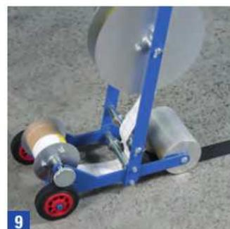
Far passare il nastro e la pellicola attraverso le aste 1 e 2. Fissare la pellicola con del nastro adesivo al rullo avvolgitore.
