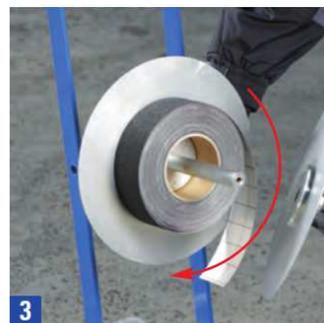
Rimettere il supporto sulla barra porta rotolo e fissare per mezzo delle viti a farfalla:
