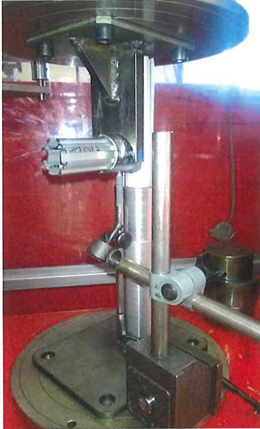
Carico per raggiungimento 1 mm di scivolamento complessivo: 150 KgCarico di scivolamento : 100 Kg
