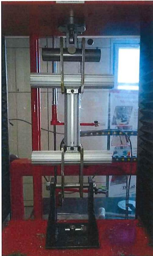
Carico per raggiungimento 1 mm di sfilamento complessivo: 400 Kg
