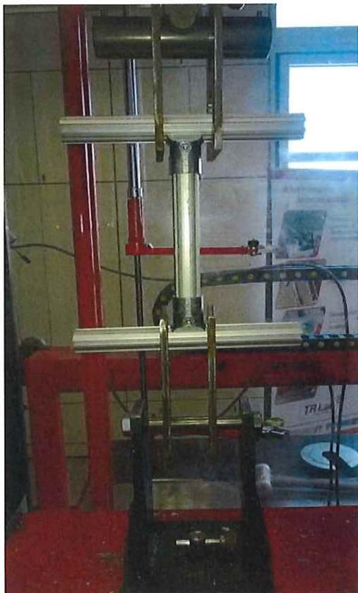
Carico per raggiungimento 1 mm di sfilamento complessivo: **225 Kg**
