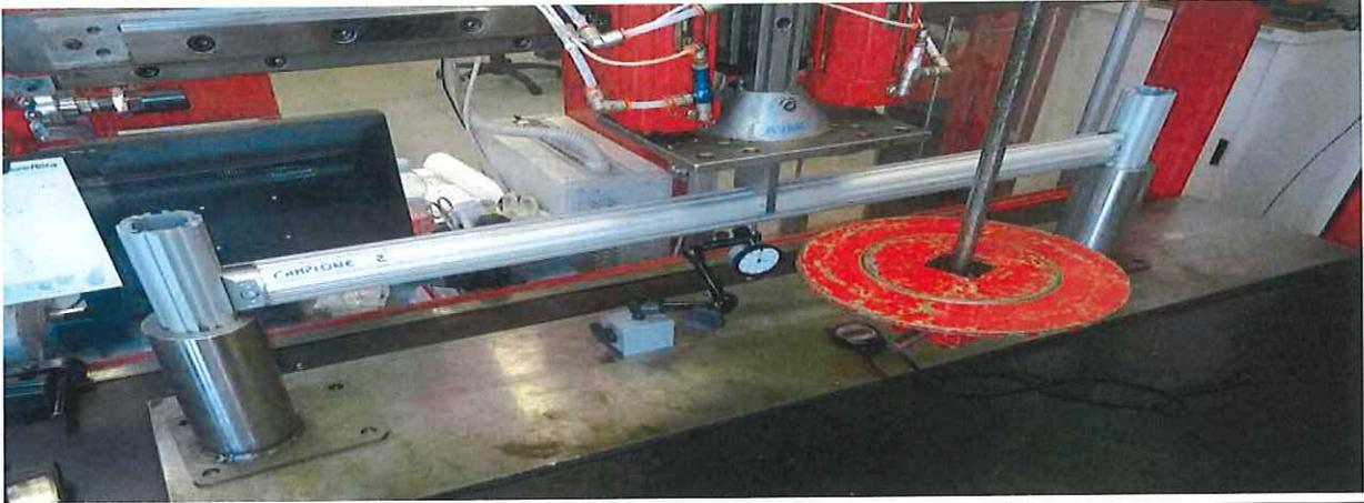
**Esito Prova**Tempo di attesa dopo applicazione carico: 30 secDeformazione Massima rilevata : 5,08 mmUtilizzato comparatore centesimale: CM 11037Deformazione residua dopo 2 min: 0,04 mm
