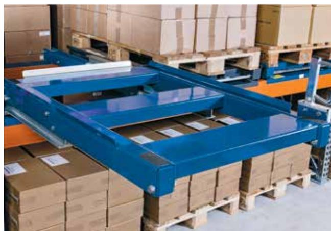
L'elevata portata unitamente alla possibilità di estrarre il telaio al 100% fa sì che questa variante possa essere installata ovunque.
